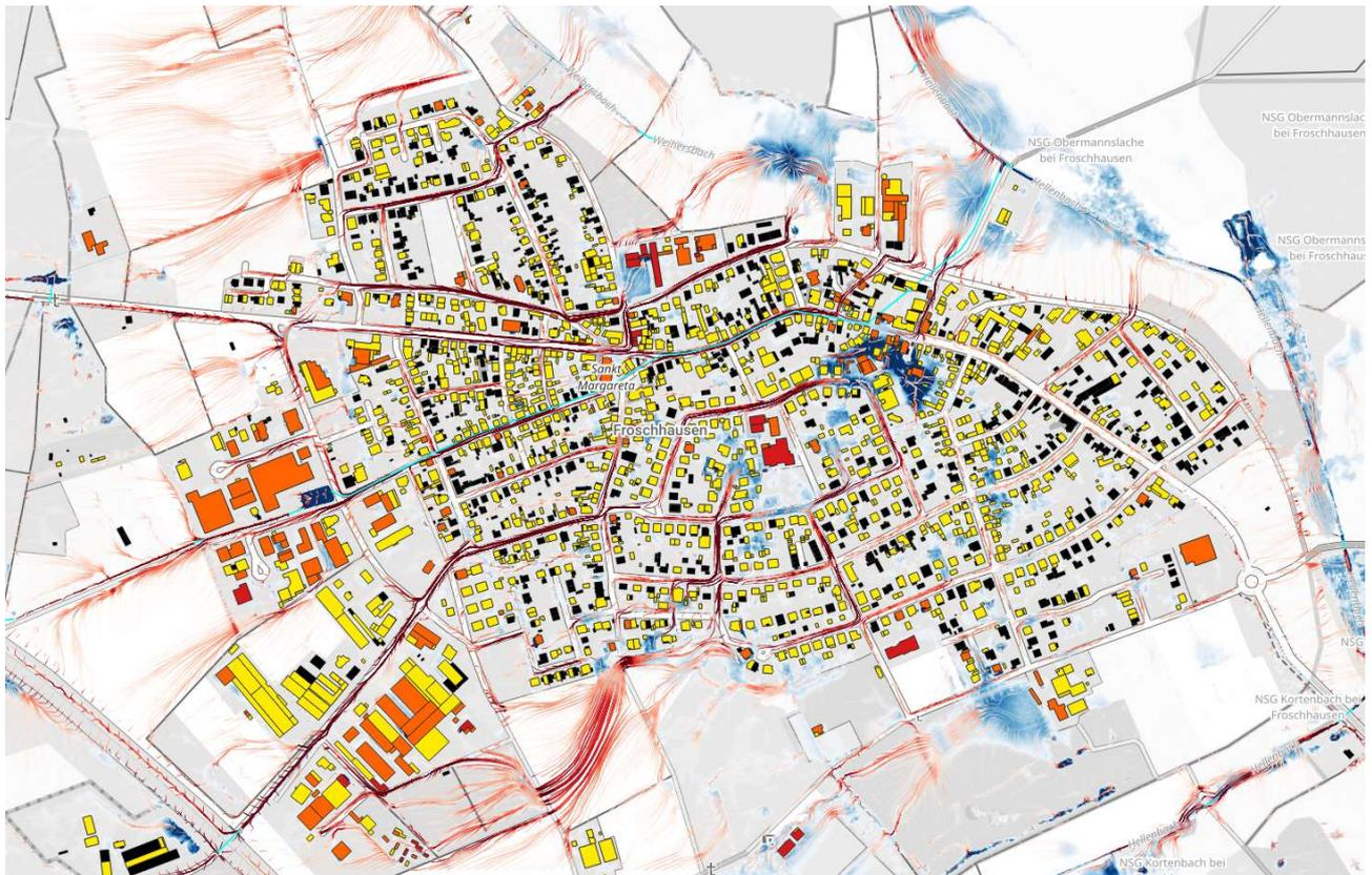
Abbildung 27: Max. auftretende Überflutungshöhen bei dem Radolan Ereignis von 2003 Starkregen im Stadtteil Froschhausen. Die Stromlinien sind in roter Farbe dargestellt, dabei variiert die Farbgebung von Weiß (0.0 m/s) bis Rot (0.5 m/s). (Hintergrund: Base-map.de)
