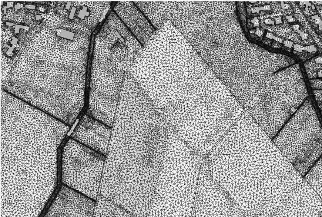
Abbildung 15: Darstellung der Vermaschung im Bereich des Außengebietes mit den im Detailgrade des DGM1 erfassten Gräben im Gitternetz. Hier ist die Kantenlänge mithin 0,1m.
